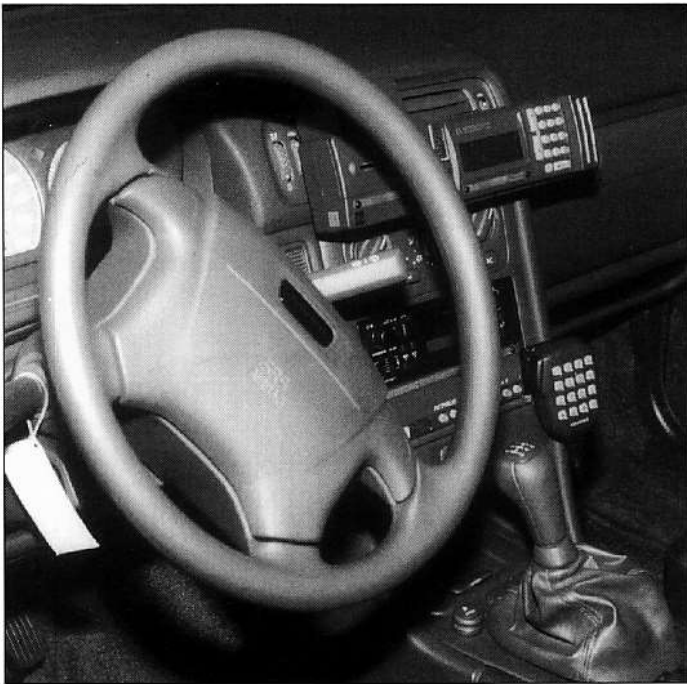
Helemaal bovenaan de terminal, achter de microfoon de taximeter
